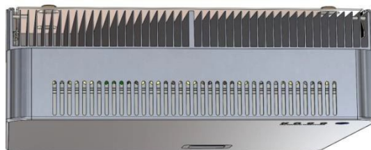
Fig. 63: Radiator fins and top air outlet
