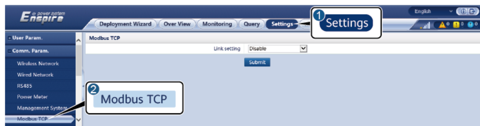
Figure 6-14 Setting Modbus TCP parameters
