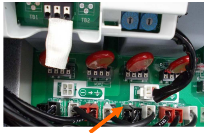
Abb. 14B – Positive Erdung
