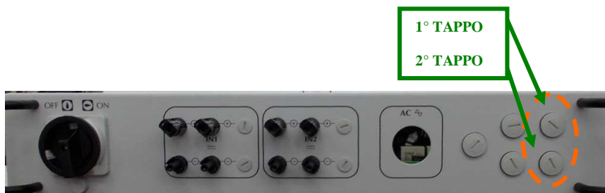
Fig. 24 - Passaggio cavi per connessione RS-485
