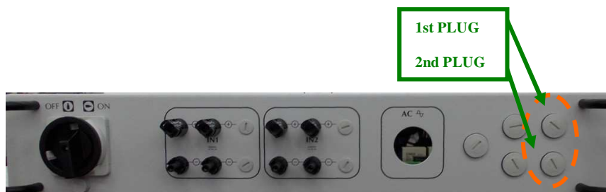
Fig. 24 - Cheminement du câble pour la connexion RS-485
