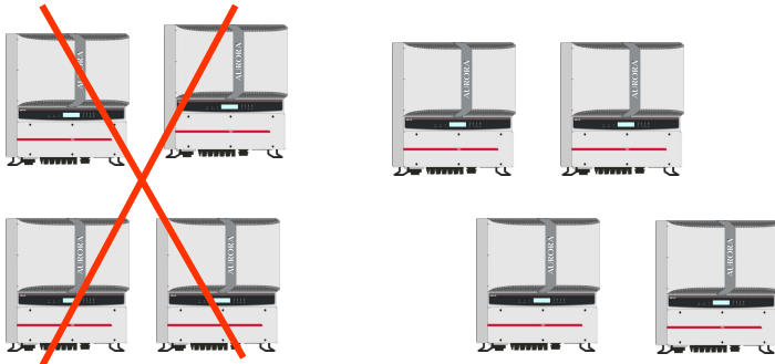
Abb. 4 - Installationsort - Erforderlicher Mindestfreiraum rund um AURORA
