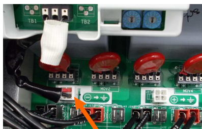
Fig. 14A - Mise à la terre au pôle négatif
