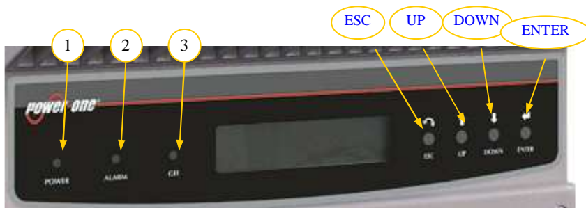
Fig. 20 - Collocazione dei pulsanti e dei LED
