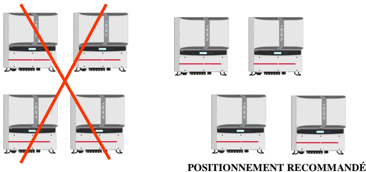
Fig. 5 - Installation recommandée des onduleurs Aurora
