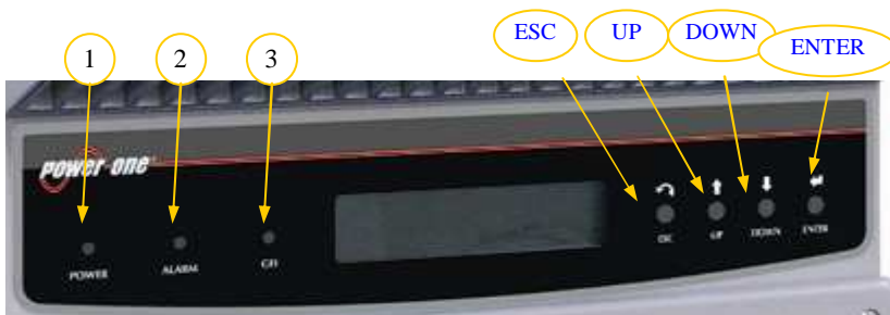
Fig. 20 - Emplacement des boutons et des voyants
